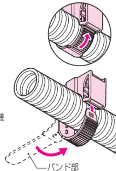
② バンド部を、挿入口に差し込み、ガタツキがなくなるまでシッカリ押し込みます。
