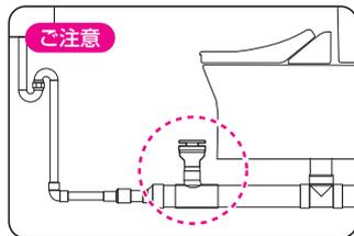
トイレでは、雑排水と汚水に別々の通気が必要です。2階トイレの配管等で、やむを得ず同一配管にする場合は、VVD-50相当の通気弁を主管側に設置してください。
