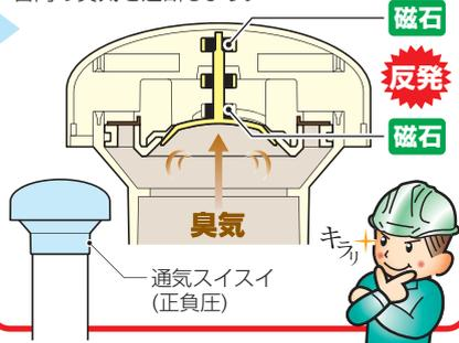
●通常時は臭気を遮断していますが、排水管内に正圧・負圧が発生した場合には弁が開き、空気の出し入れを行います。
