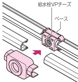
付属のプラグをチーズボックスのベースに通し、既設の配管口にねじ込むだけでベースを固定でき、従来の配管口と同じ位置に取り付けることができます。
