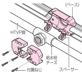
別売の給水栓ボックス用スペーサー(RMB-S2)を水栓取り出し口に接着固定し、持ち出し高さ調整をします。
