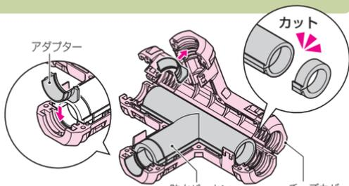
①取付口の管のサイズに合わせて、アダプターの取り付け又は防水パッキンのカットをします。
