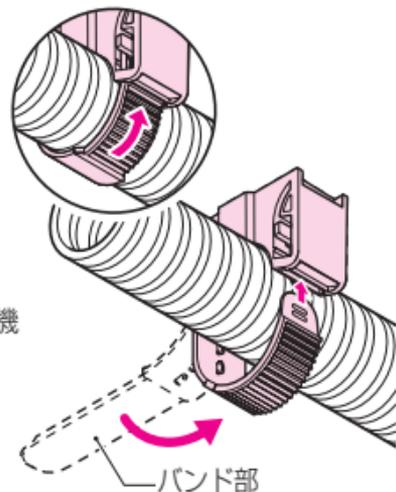
② バンド部を、挿入口に差し込み、ガタツキがなくなるまでシッカリ押し込みます。
