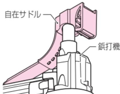
① 鋸打機で、自在サドルを天井等に固定します。
