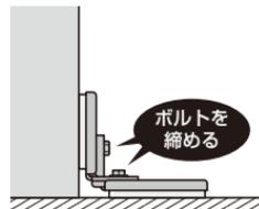
下側ボルトの推奨締付トルク: 3.5N・m
