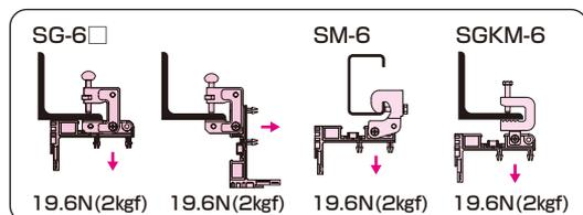
※斜めボックス、断熱カバー付きには使用できません。電気亜鉛めっき仕様(金属部) RoHS対応
