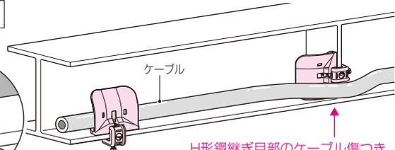
H形鋼継ぎ目部のケーブル傷つき防止ガードとしても使用できます。
