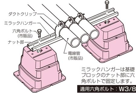
ミラックハンガーは基礎ブロックのナット部に六角ボルトで固定します。
