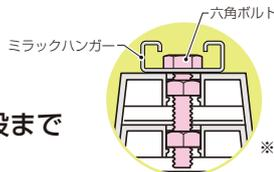
※W3/8の六角ボルトで確実に連結固定ができます。
