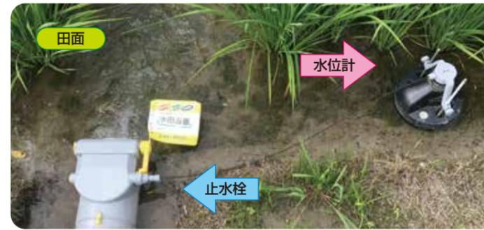
水位計を必要な水位に設定し、止水栓を取水口に水位計を田面に設置します。
