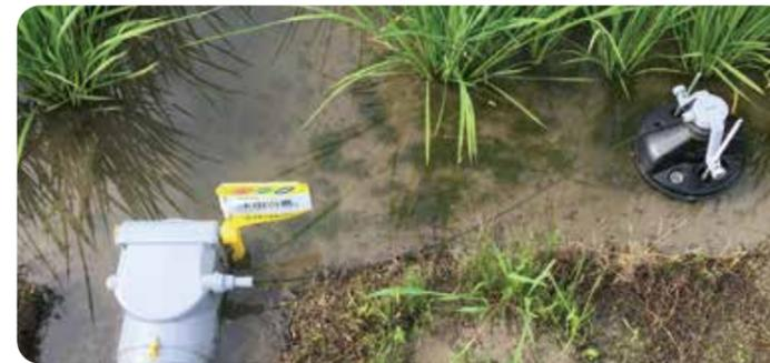
設定した水位に到達すると止水栓の弁が閉じ、水が止まります。
