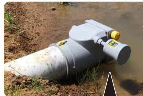
タイマーを止水栓に取り付け、止水したい時間を設定します。
