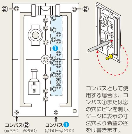
コンパスとして使用する場合は、コンパス①または②の穴にピンを刺し、ゲージに表示の寸法より希望の径をけ書きします。
