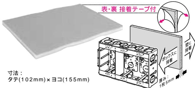
スライドボックスの裏面に貼り付け、断熱材の一部として使用します。テープ付で壁面に仮固定できます。シートを重ね合わせて、壁空間のすき間に対応できます。
