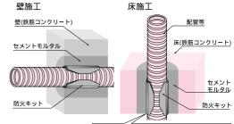
防火キット下側の端面と床面を合わせるようにセットして下さい。
