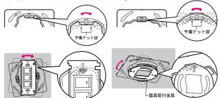
予備ナット部を利用し、取付枠をタッピンねじ(呼び3.8)で取り付けます。
