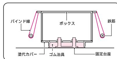
固定台座をベッド面に溶接固定し、ゴム治具を固定台座に固定します。
