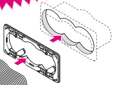
壁厚に合わせ、ジャバラを切断し、ベース部より壁内にはめ込み、フィルターを挟み込み、カバーを取り付けます。
