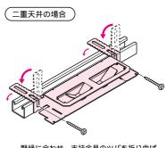
野縁に合わせ、支持金具のツバを折り曲げ、 タッピンねじで固定します。
