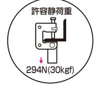
インサート用ケーブルハンガーと組み合わせることによりケーブル支持に使用できます。
