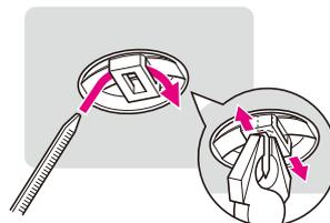
②型枠を取り外した後、釘をこじて抜き取り、結束バンド等をフックに通します。
