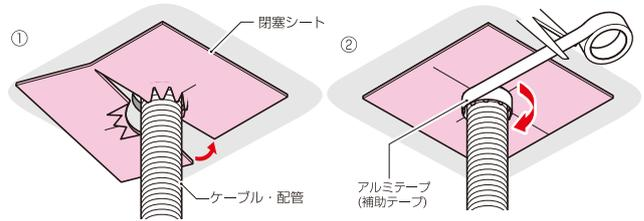
●補助シートとしてアルミテープは必ず幅30mm以上、アルミ箔厚み0.05mm以上の物が別途必要です。
