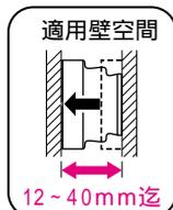
GL工法等、壁空間の狭い箇所に最適です。背面の壁に直接取り付ける直張り用ボックスです。(柱にもそのまま取り付けられます。)
