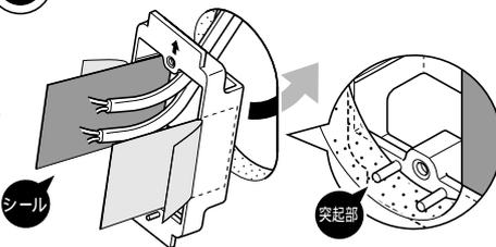
シールをボックスの両サイド内面に貼る。壁内のケーブルをボックスに通す。ボックスを壁内に入れ込み、突起部をボード切断面にのせ、シールで壁に仮固定。
