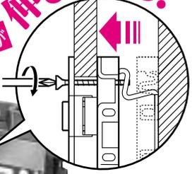
ビスを締めればボックスが伸びてはさみ固定されます。
