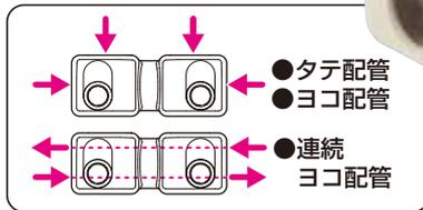
上記の混合水栓配管に施工でき、
