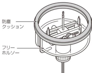
① 防塵クッションの切り欠き部をフリーホルソーのカバー外周の替刃入れ凸部に合わせ、はめ込みます。
