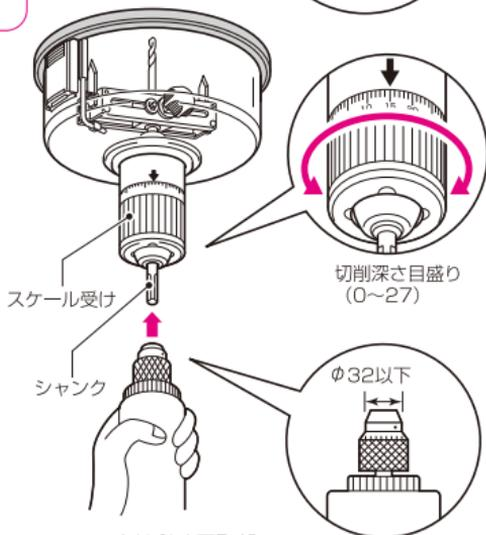
※シャンクは必ず面取部分に合わせて確実にチャックしてください。
