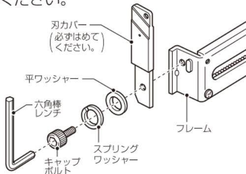
板刃は必ず図の向き(同一方向)に取り付けてください。
