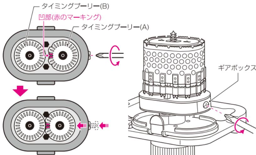
④刃のタイミングベルト部分を持ち、タイミングブーリーに掛かっているベルトを片側ずつ外し刃を抜き取ります。
