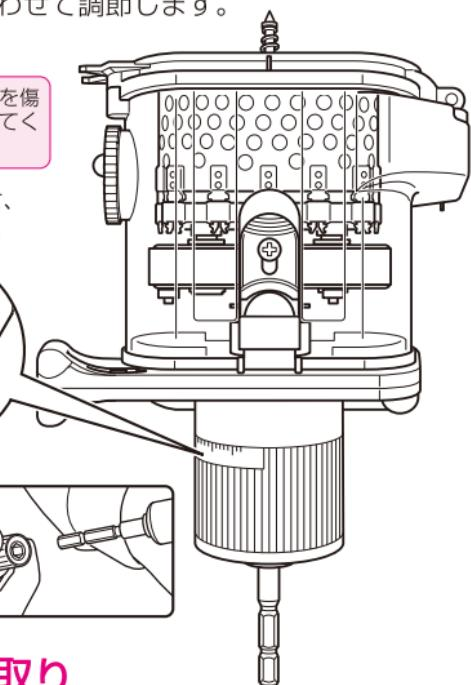
シャンク軸は必ず面取部分にあわせて確実にチャックしてください。
