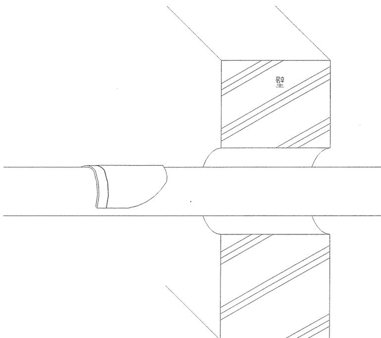
ウ 防火キットのリブ側端面位置が、壁面より面一以上10mm以下の位置となるようずらす。
