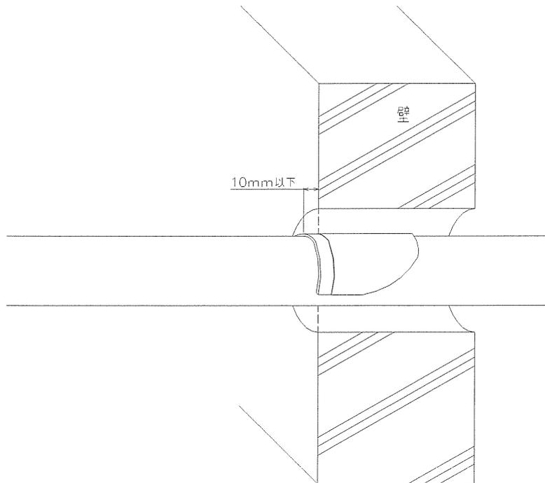
エ 防火キットと開口部との隙間に壁の両側からセメントモルタル（セメント：1に対して砂：3の容積割合）を隙間なく充填する。または、壁面的一方に板等により仮押えをし、セメントモルタルを隙間なく充填し、セメントモルタル硬化後板等を取除き、隙間のないことを確認する。
