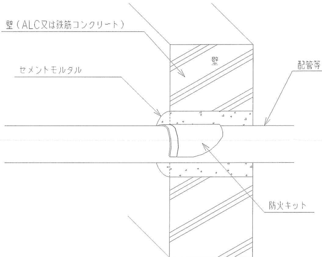
図-1 防火キットの構造
