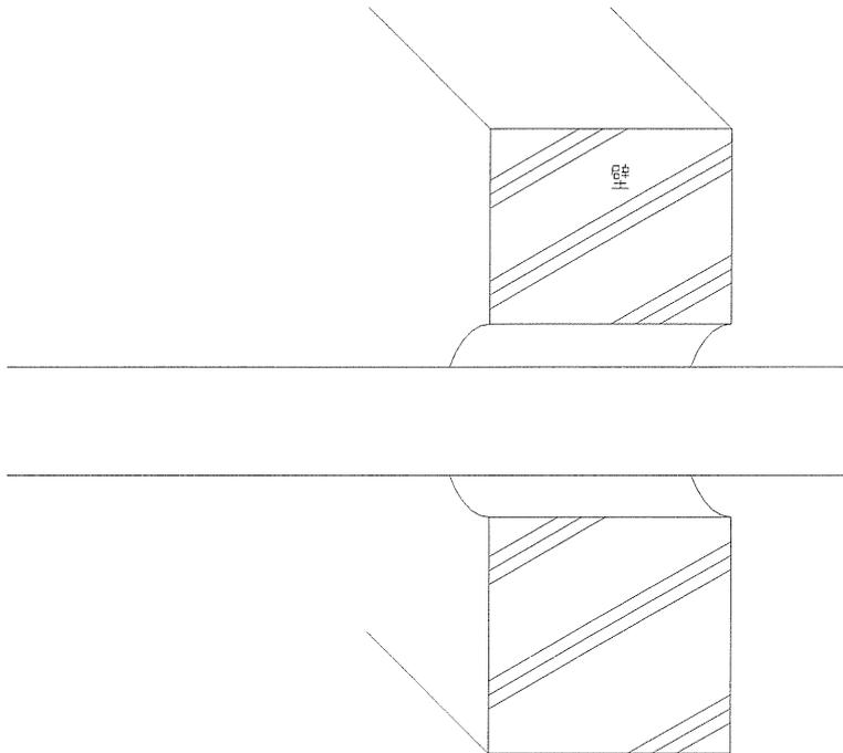
イ 開口部の外側でリブが外側になるよう防火キットを配管に装着する。
