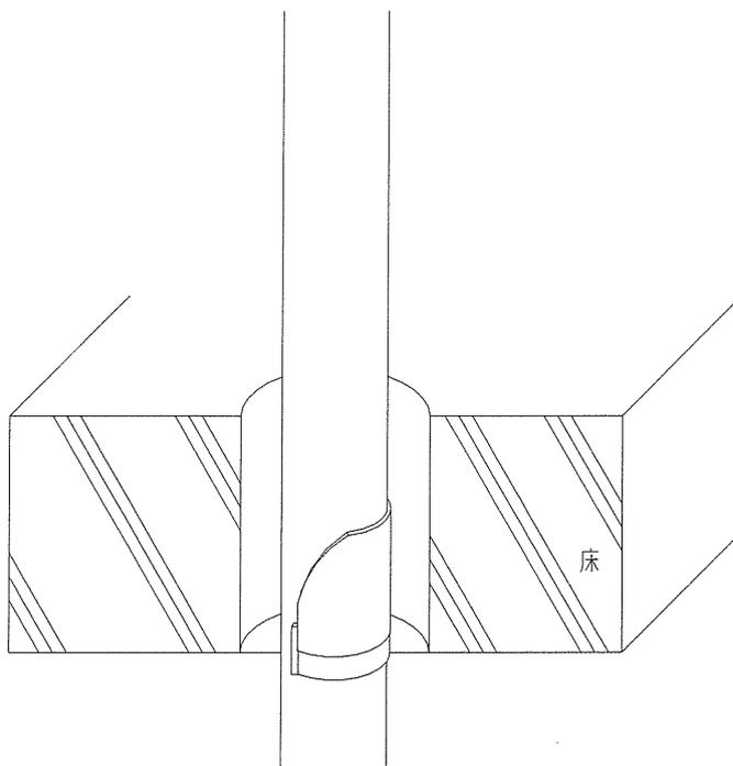
エ 床下面に板等により仮押えをし、防火キットF P Kと開口部との隙間に床上面からセメントモルタル（セメント：1に対して砂：3の容積割合）を隙間なく充てる。セメントモルタル硬化後に板等を取除き、隙間のないことを確認する。
