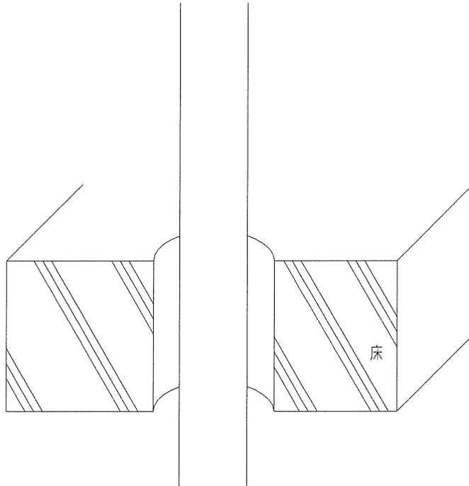
イ 開口部の外側でリブが下側になるよう防火キットF P Kを配管に装着する。
