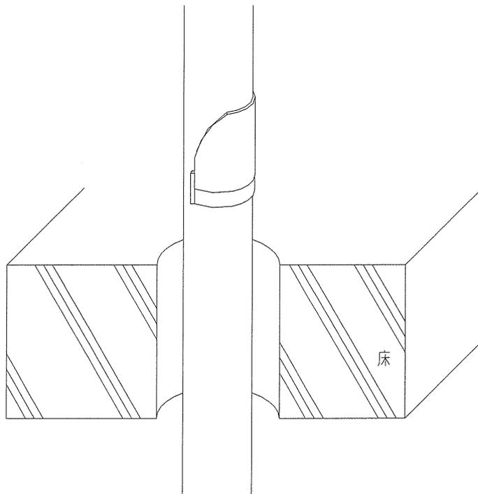
ウ 防火キットF P Kのリブ側端面位置が、床下面と同一面の位置となるようにずらす
