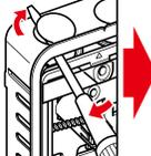
鋼製カバーのノックに通線部材に合わせ、施工します。
