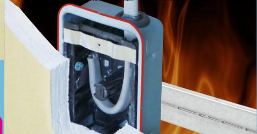
厚さ12.5mm以上のせっこうボードを木間柱とボックスの間に挟んで固定するか、金属製のステー(調整固定バー等)を用いる固定をし、所轄行政機関にご確認のうえ、施工してください。
