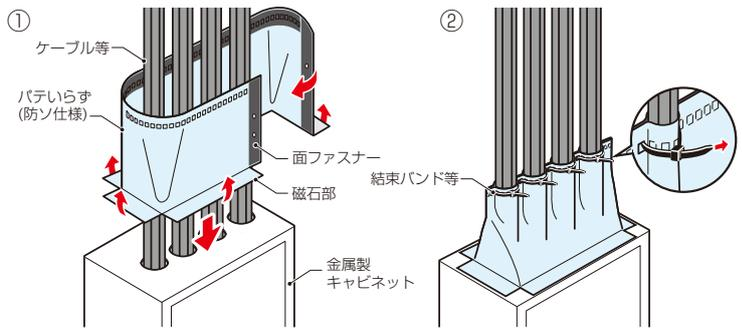
①パテいらずをケーブル全部を覆うように巻き付け、端部の面ファスナーで固定します。底面の磁石部分を折り曲げ、金属製のキャビネットに固定します。
